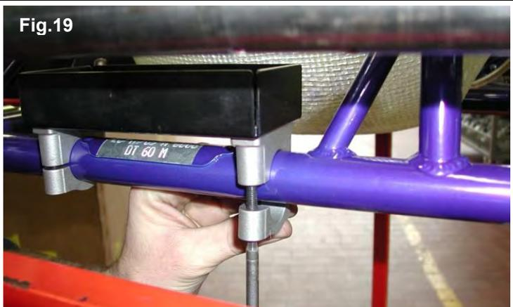
**3.7.3** INSERT THE STRAP INTO THE SUPPORT SLOTS
